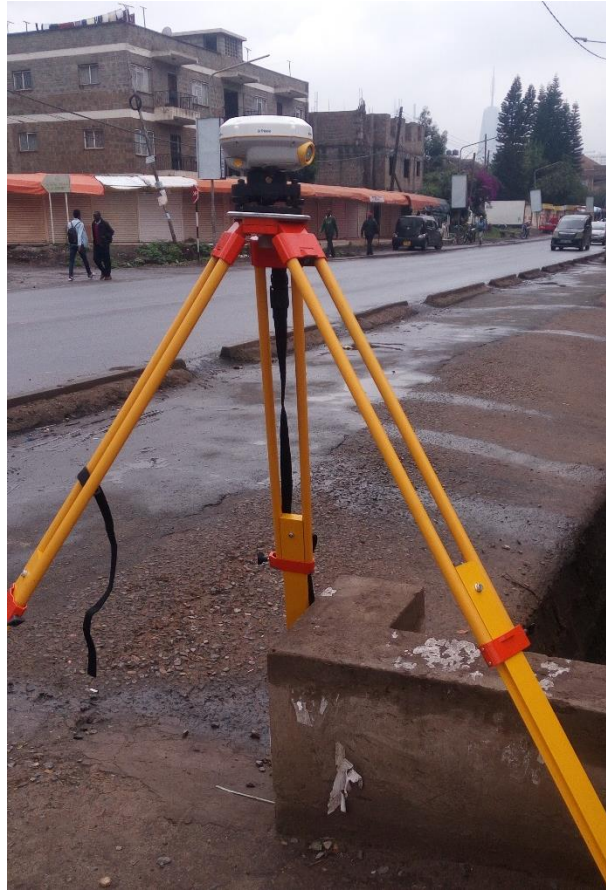
Top edge of culvert (GCP 6)
