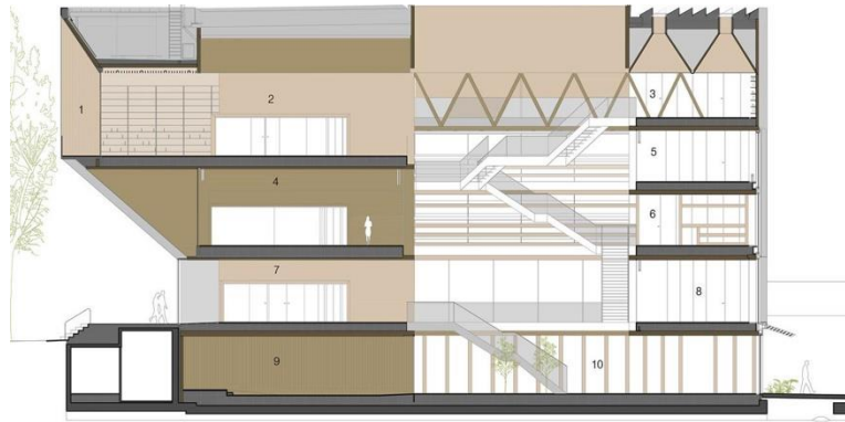
sección transversal a-a' cross section a-a' 1. balcón, balcony 2. palacio de la lectura, reading palace 3. espacio de concentración, study room 4. biblioteca infantil y juvenil, children's/youth library 5. administración, administration 6. el parque, the park 7. acogida, library access 8. foro de ideas, ideas forum 9. sala polivalente, multipurpose space 10. patio, atrium
